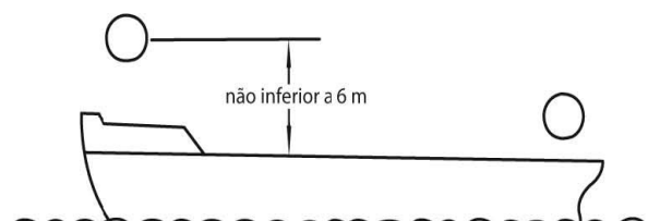
Figura 108 - Navio de comprimento igual ou superior a 50 metros fundeado [Anexo I, 2.k)].
