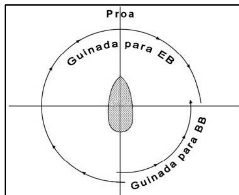
Figura 20 - Esquema com as guinadas aconselhadas (caso se opte por guinada) em visibilidade reduzida, não contemplando o caso de navio alcançante.
