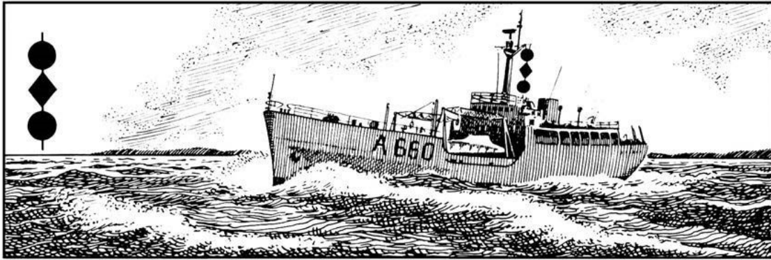
Figura 65 - Navio hidrográfico a executar levantamento hidrográfico. Este sinal aplica-se a todos os navios com capacidade de manobra reduzida (exceto navios a dragar e em limpeza de minas).
